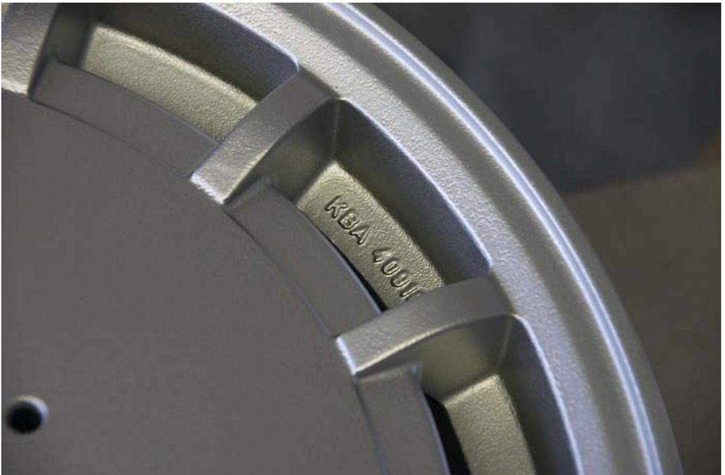
Nun kommt der Klarlack drauf. Ich bin der Meinung dass das die Komponente ist an der man bei Felgen am wenigsten sparen sollte. Der wird durch den Bremsstaub und den darauf folgenden Felgenreiniger sehr stark belastet. Ich bin mir auch alles andere als sicher dass so ein Einkomponentenlack aus der Dose generell überhaupt in der Lage ist das auszuhalten. Ich lasse es halt einfach mal drauf an kommen. Die Belastung ist beim 200D ja
