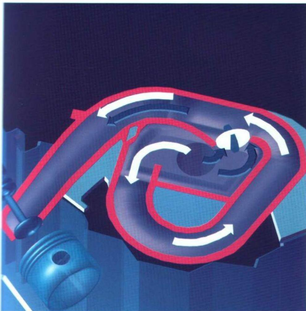
Variables Schaltsaugrohr beim 2.8 E zur Erzielung eines starken Drehmoments im unteren Drehzahlbereich mit langem Ansaugweg (weiße Pfeile). Und gesteigerter Leistung im Drehzahlbereich über 4100 1/min durch kurzen Ansaugweg (blaue Pfeile).  $v_{90}$
