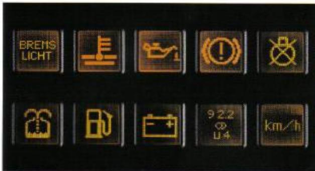
Auto-Check-System mit akustischer und automatischer Überwachungsfunktion für: Bremslicht, Kühlflüssigkeitsstand und -temperatur, Motor-Öldruck, Bremsstörung, Abblend- und Rücklicht, Scheibenwaschwasser, Kraftstoffreserve, Batteriespannung, Frequenzanzeige (nur in Verbindung mit dem Radio „gamma CC“), Geschwindigkeitswarnung. OK-Anzeige: Sind in Ihrem Fahrzeug die vom Auto-Check-System geprüften Funktionen in Ordnung, leuchtet „OK“ auf.
