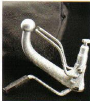
Anhängervorrichtung mit abnehmbarem Kugelhals und praktischer Tasche. 13poliger Steckdose am Querträger, Verkabelung, Anhänger-Blinker-Kontrolleuchte im Kombi-Instrument und einem Stützlast- und Typschild.
