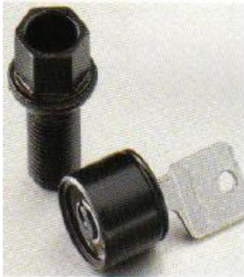
Abschließbare Radschrauben – ein wirksamer Diebstahlschutz. Pro Rad wird eine abschließbare Schraube verwendet.
