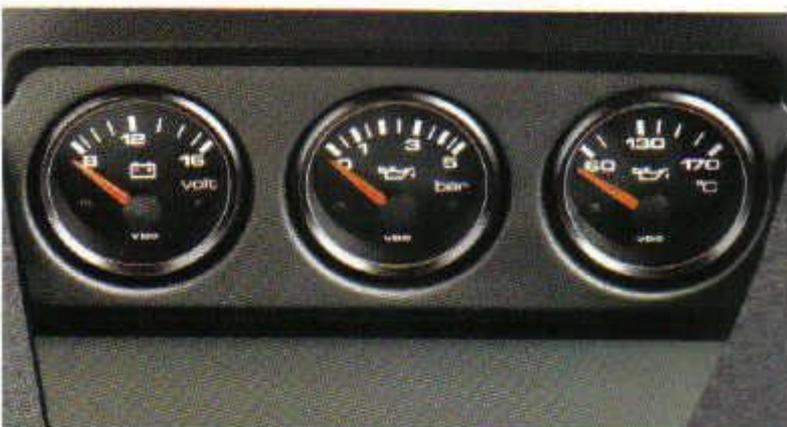
Zusatzinstrumente in der Mittelkonsole: Voltmeter, Öldruckmesser und Öltemperaturanzeige.
