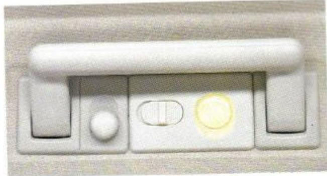
Innenleuchte mit Abschaltverzögerung, 30 Sekunden nach dem Türschließen erlischt das Licht.
