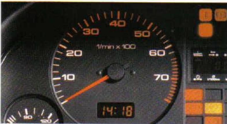
Elektronischer Drehzahlmesser mit Digital-Zeituhr.
