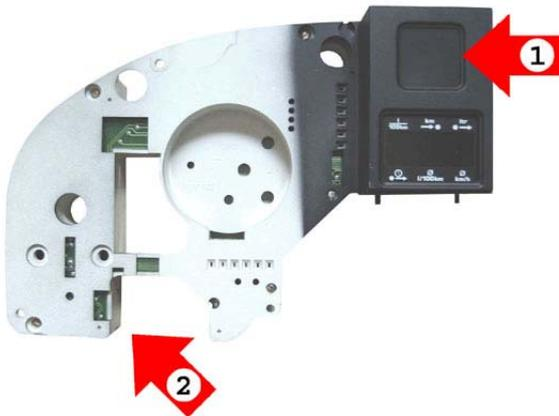
Bild 5: BC mit Kontrollleuchteinheit Vorderseite
