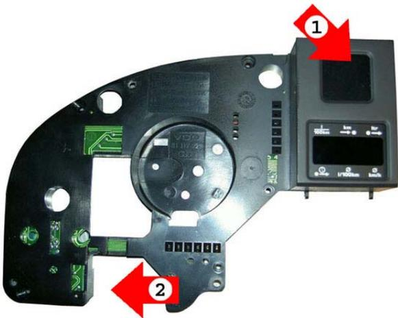
Bild 17: BC mit Mini-Check-System Vorderseite
