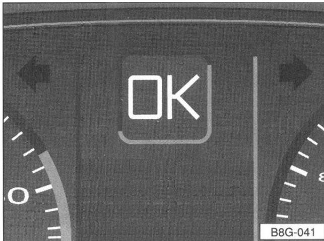
Bild 7: Auto-Check-System Anzeigen
